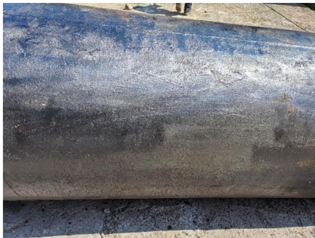
Рис. 3 Чугунная водопроводная труба Ду 800 мм (после удаления грунта металлической щеткой) прокладки 1900 г., извлеченная в 2025 г. при реконструкции водовода на Васильевском острове, после 125 лет безаварийной эксплуатации.
