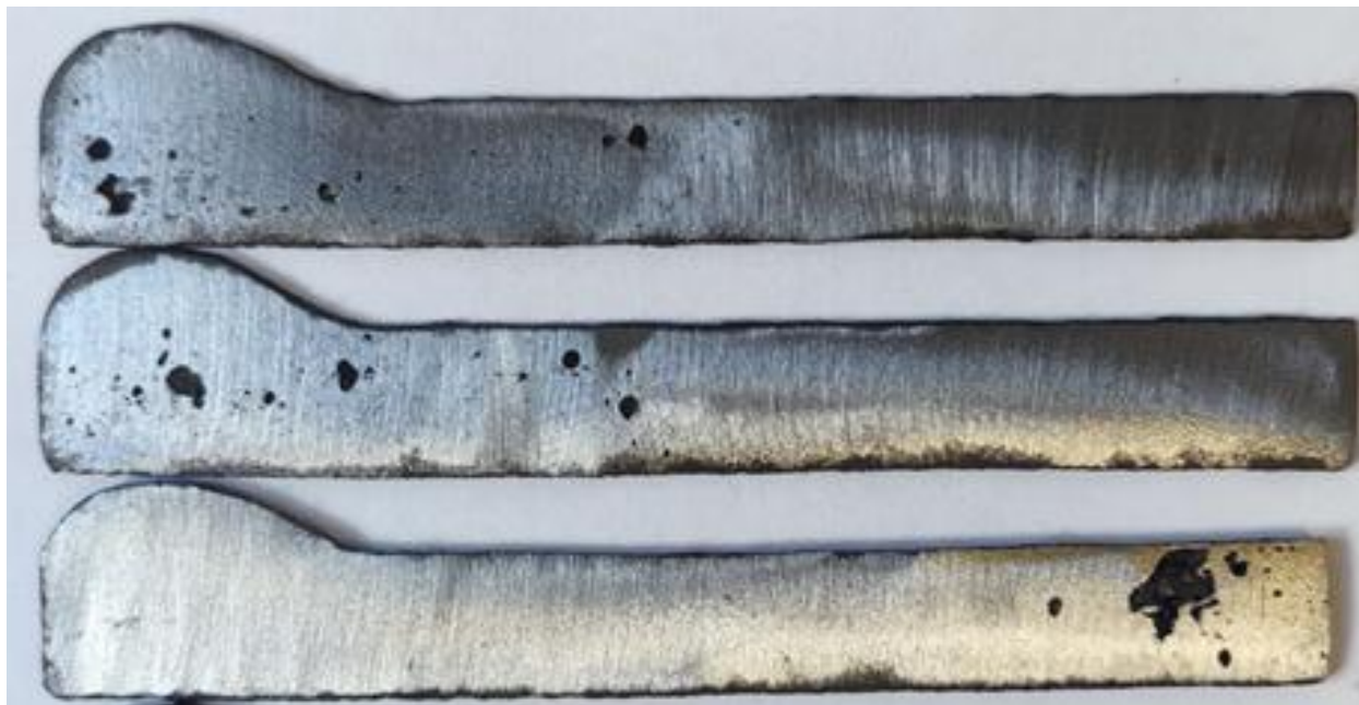
Рис. 6 Литейные дефекты в трубе Ду 800 мм в виде газовых пор и усадочных раковин.
