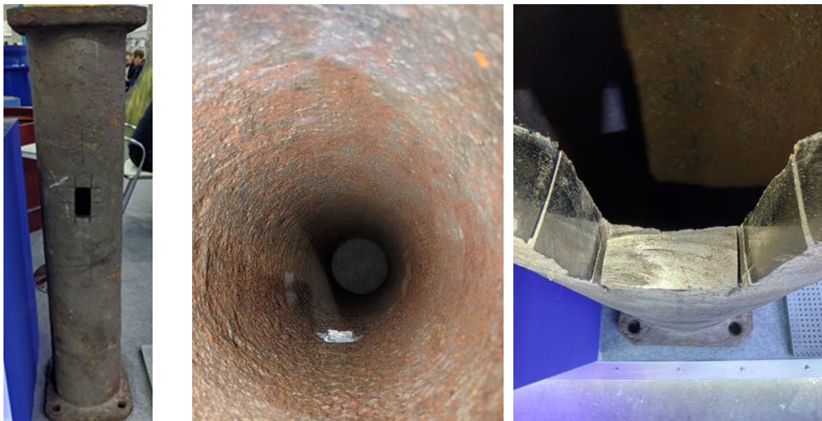
Рис.1 Внешний вид чугунной трубы после 278 лет эксплуатации в системе подачи воды к фонтанам Петродворца.
