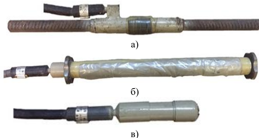
Рис.1. СП систем СМИС, выпускаемые в России: а – ПСАС-М-20Р; б – ПЛДС-400; в – ПДС-3П
