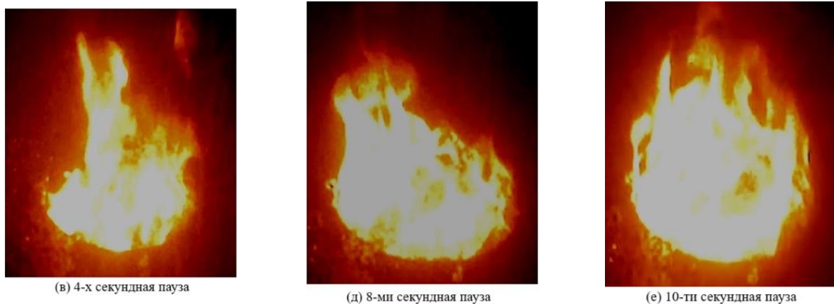
Рис. 5. Изображения пламени в разных точках во время пауз в циклах импульсов.
