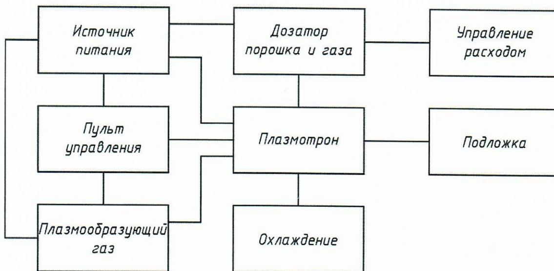
Рис. 2. Структурная схема процесса плазменного напыления
