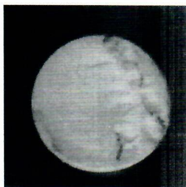
Рис. 5 – Срез гранулы ионообменной смолы Purolite s914 при увеличении x200
