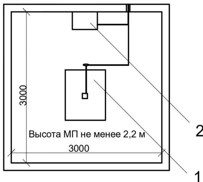
Рис. 3. План машинного помещения (1 – шкаф управления; 2 – гидроагрегат)
