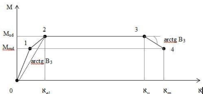
Рисунок 2. Расчетная диаграмма M - \chi изгибаемого элемента несущей конструкции, армированного сталью
