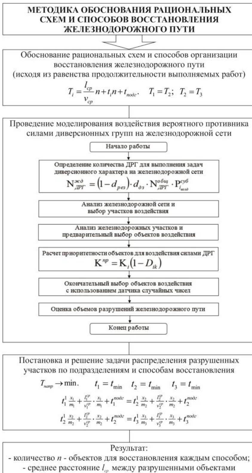
Рис. 10. Блок-схема методики обоснования рациональных схем и способов восстановления железнодорожного пути
