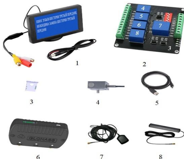
Рис. 2 – Вариант комплекта системы предупредительной дистанционной автоматизированной диагностики технического состояния ВАТ на примере коробки переключения передач.
