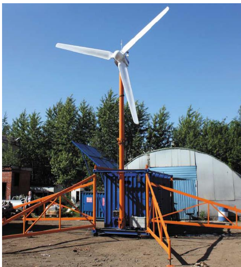
Рис. 2. Гибридная контейнерная блочно-транспортабельная система электроснабжения [6]
