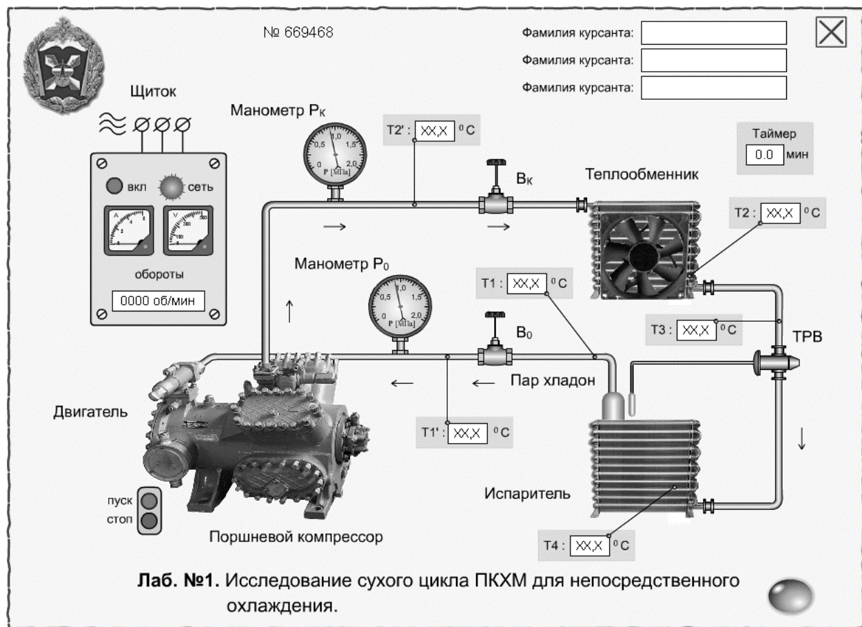
Рис. 2 – Лабораторная установка ПКХМ с непосредственным охлаждением
