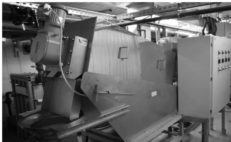
Рис. 2. Шнековый обезвоживатель ES201
