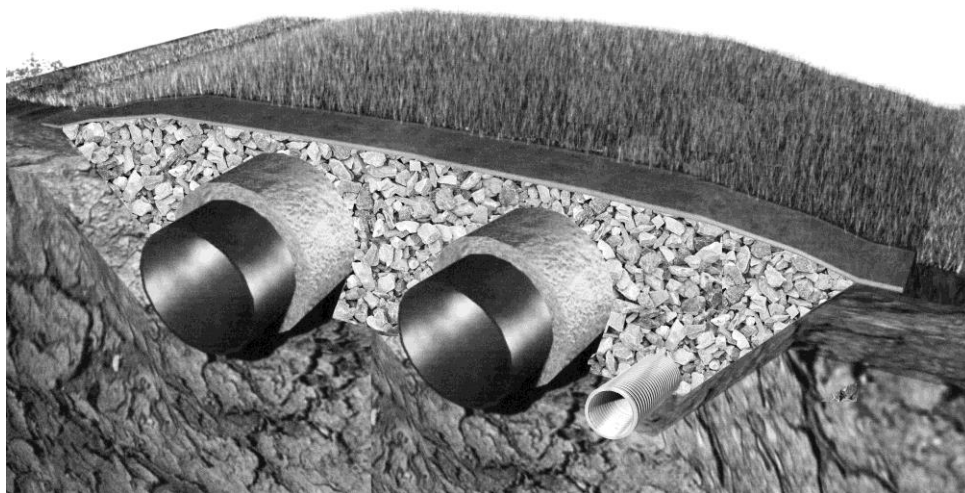
Рис. 3. Наземная прокладка трубопроводов с грунтовой обваловкой
