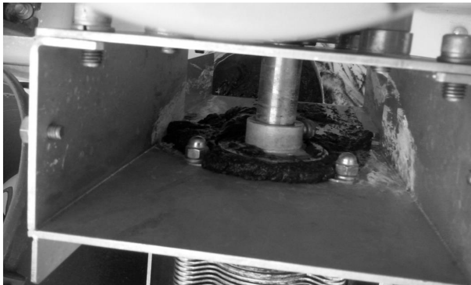
Рис. 7. Обезвоженный осадок влажностью 90% полученный из промывной воды.
