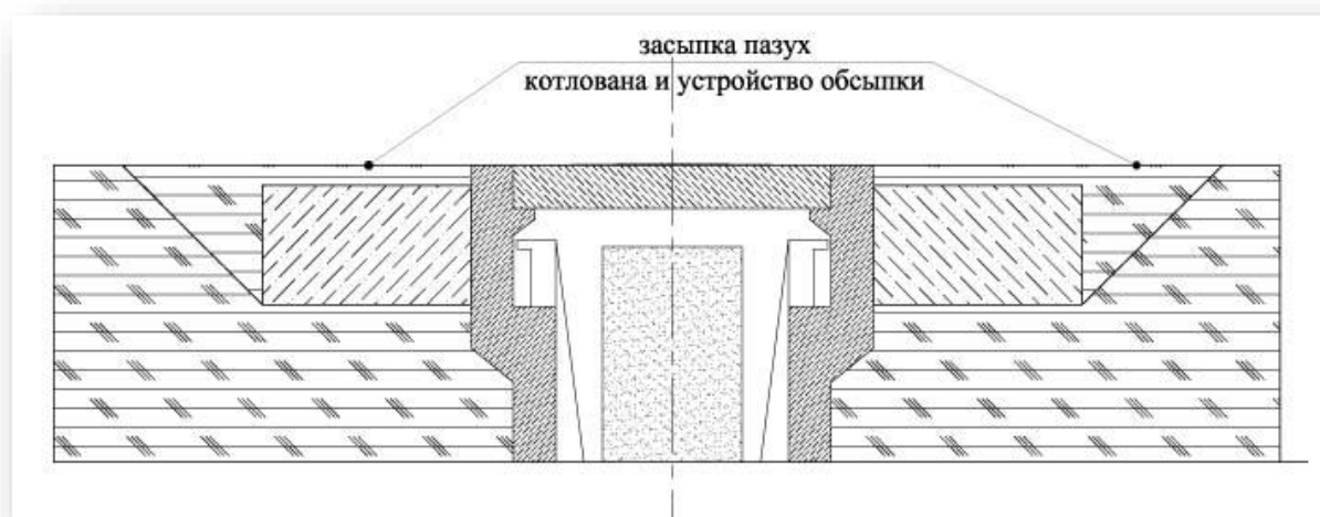
Рисунок 5. Устройство железобетонного тюфяка
