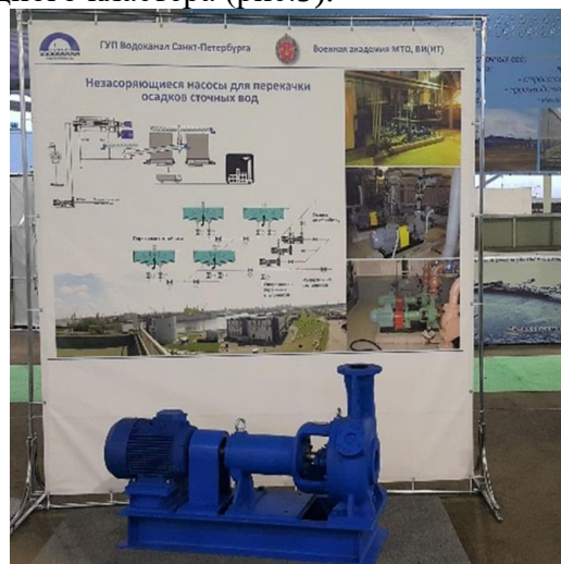
Рис.9. Незасоряющийся насос для перекачки осадков сточных вод.
