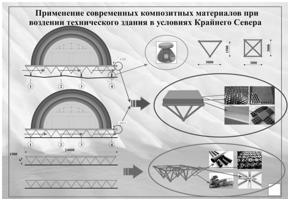
Рис. 11. Пространственные конструкции в качестве оснований
