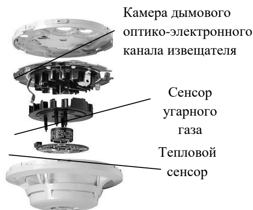
Рис. 4. Конструкция мультисенсорного (мультикритериального) пожарного извещателя
