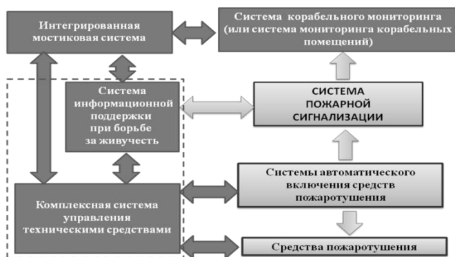
Рисунок 3 Схема информационных связей системы пожарной сигнализации
