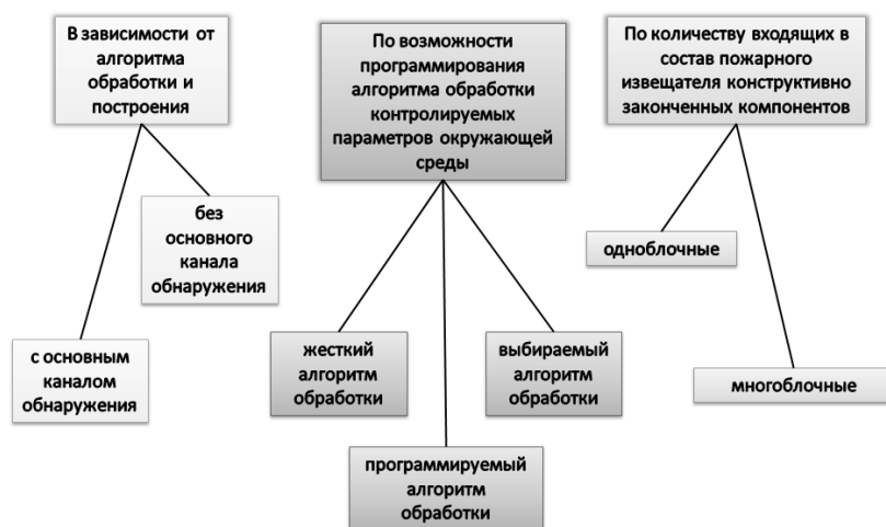
Рис. 7. Классификация мультикритериальных пожарных извещателей
