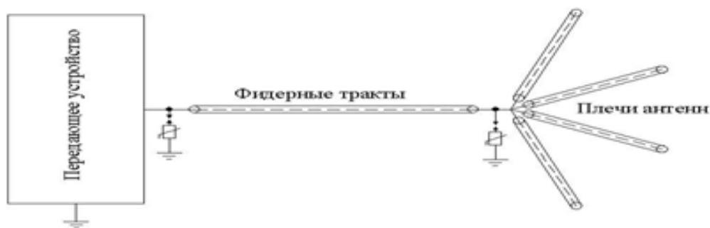
Рис. 7. Условная однолинейная схема модуля радиопередающего комплекса с установкой УЗИП на входе РПДК и в месте сопряжения вибраторов и фидерных трактов
