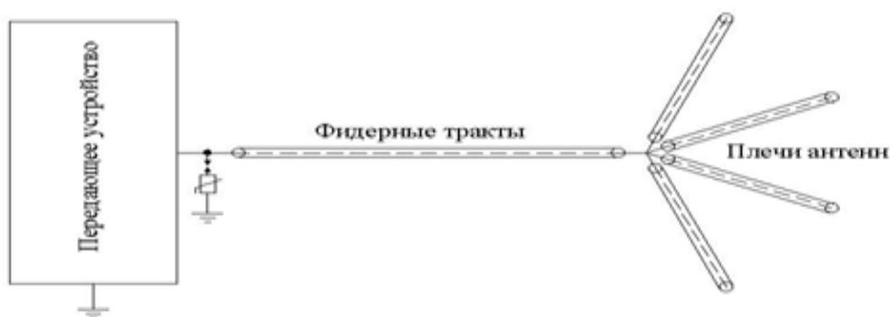
Рис.6. Условная однолинейная схема модуля радиопередающего комплекса с установкой УЗИП на входе РПДК
