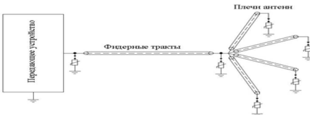
Рис. 8. Условная однолинейная схема модуля радиопередающего комплекса с установкой УЗИП на входе РПДК и в месте сопряжения вибраторов и фидерных трактов и на концах антенн
