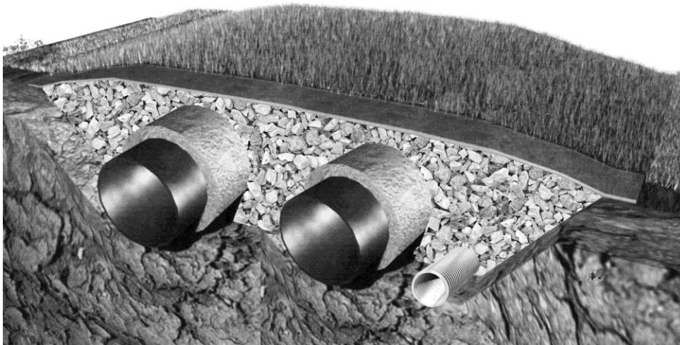
Рис. 3. Наземная прокладка трубопроводов с грунтовой обваловкой
