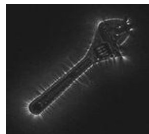
Рис. 1. Образцы визуализации коронного разряда. На ключах в местах интенсивного внешнего механического воздействия свечение более интенсивное, неравномерное.
