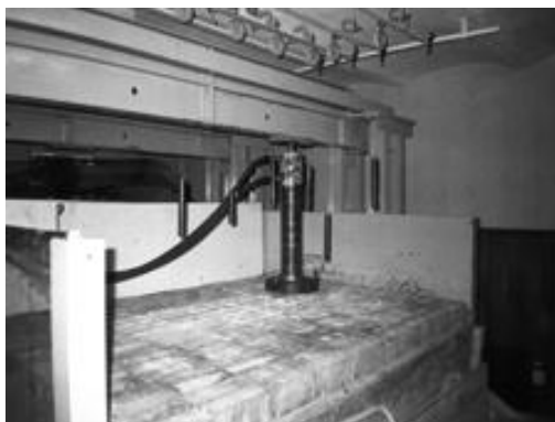
Рис. 1. Испытание дорожной одежды с покрытием из мелкоразмерных плит 8П. 8 «Паркет»
