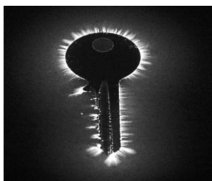
Рис. 1. Образцы визуализации коронного разряда. На ключах в местах интенсивного внешнего механического воздействия свечение более интенсивное, неравномерное.
